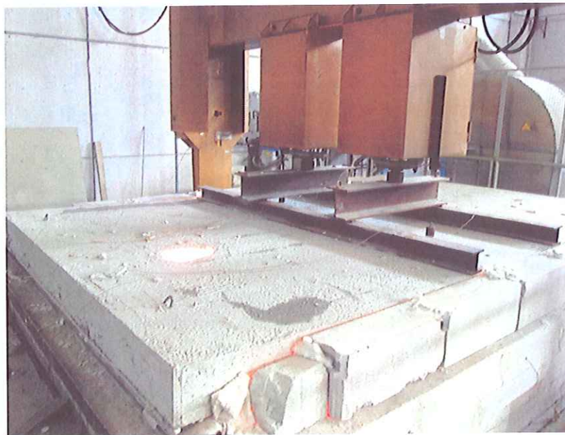
Fotografia della superficie d'estradosso del campione all'interruzione della prova.
