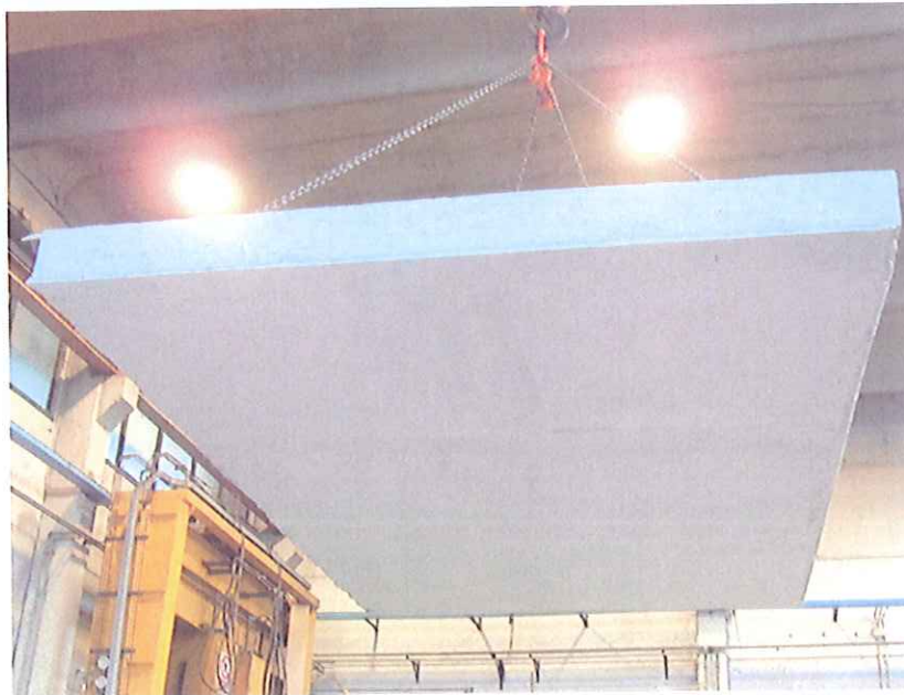
Fotografia della superficie d'intradosso del campione prima della prova.
