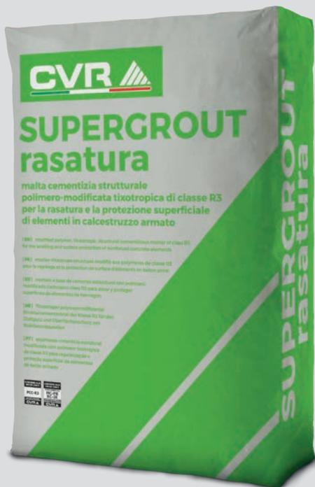
Malta cementizia strutturale polimero-modificata tixotropica ad elevate resistenze meccaniche in classe R3, fibrorinforzata a granulometria fine per la rasatura e la protezione superficiale di elementi in calcestruzzo armato in opere di ingegneria civile. Applicabile con spessore variabile da 2 a 15 mm.
